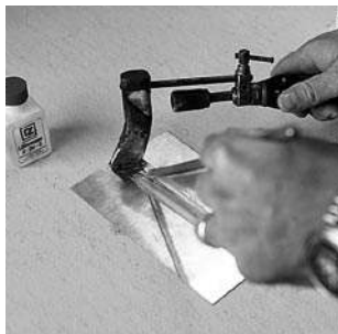
Fot. 15: Prowadzenie lutownicy
